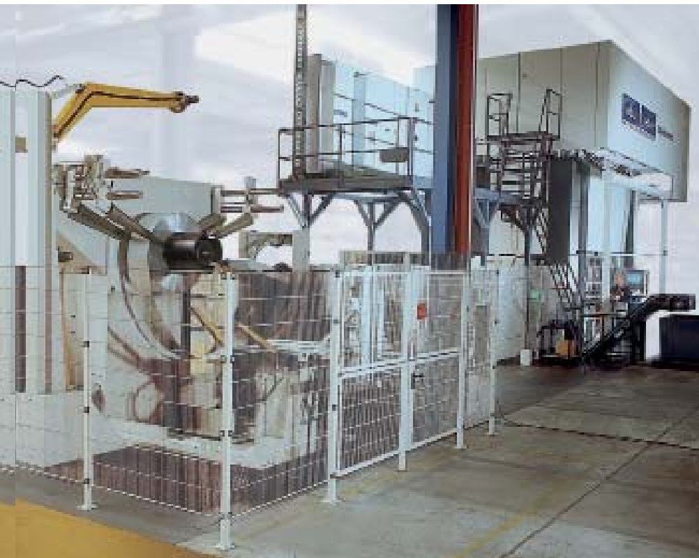
Burkhardt-Gesamtanlage, unter anderem mit Bandzufuhr, Feinrichtmaschine und Stanzautomat.
