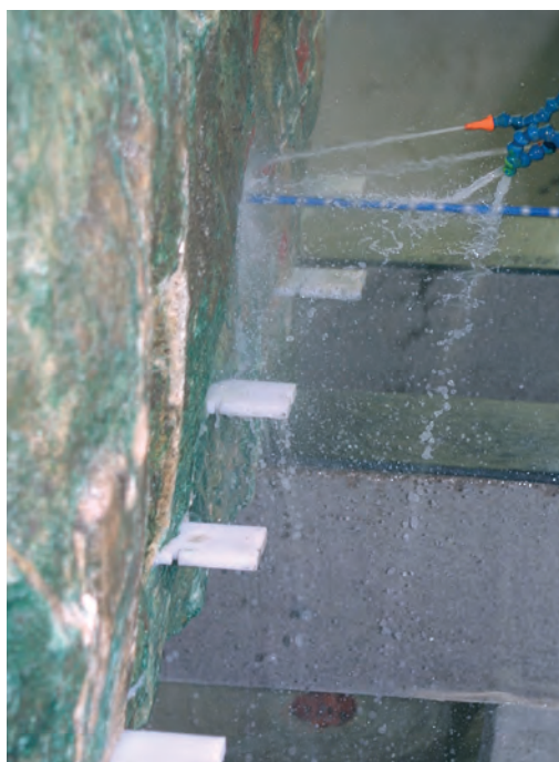
Beidseitiges, vollautomatisches Abkeilen der geschnittenen Tranchen
