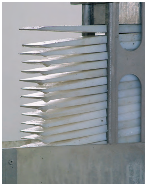
Block mit Keilmagazin, Fassungsvermögen 2 x 150 Keile
